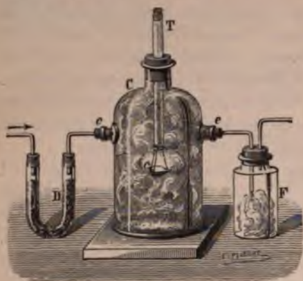
Fig. 129. — Préparation de l'acide phosphorique anhydre.
